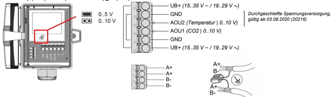
» **DIP-SCHALTER-EINSTELLUNGEN (AUFSTECKPLATINE)**
