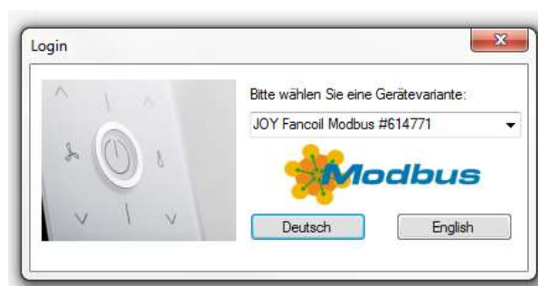
Abbildung 17 Gerätetypauswahl nach Programmstart
