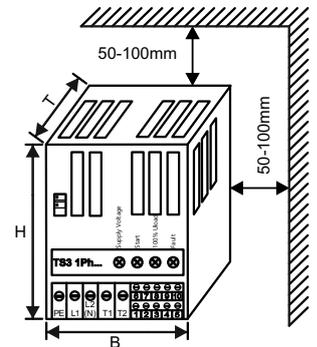
Das Gehäusegerät nach IP 54 (Option) kann an Einsatzorten montiert werden, die vor Staub und Feuchtigkeit nicht geschützt sind.
